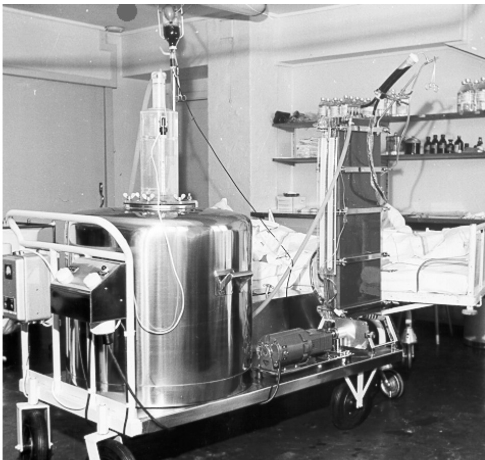
Fig. 1. Fire lags Kiil-nyre i sin opprinnelige form i drift på Forskningsinstituttet i 1967.
