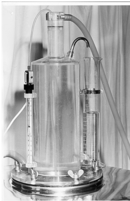
Fig. 2. Plasthatten på toppen av tanken. Overløpsrøret tillater måling av ultrafiltrasjon på ml nivå. Termometeret med termostat styrer en kokeplate som tanken står på.
